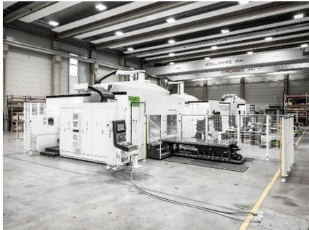
**Bild 3:** Ausstatten lässt sie sich mit Automatisierung – hier mit beidseitigem Wechsel-Schlitten.
